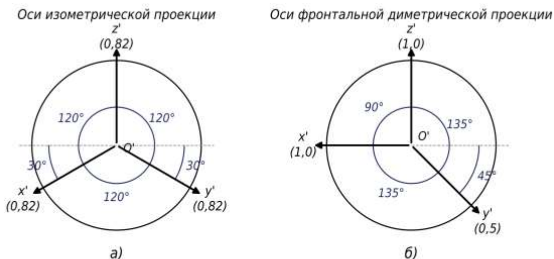
Рисунок 16 – Виды аксонометрии: а) изометрическая проекция; б) фронтальная диметрическая проекция
