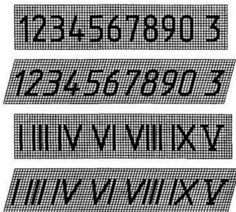
Рисунок К.3 – Арабские и римские цифры шрифтом типа Б
