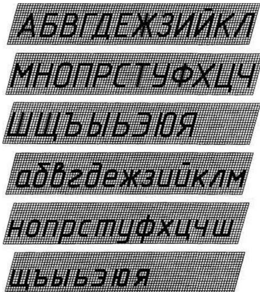
Рисунок К.1 – Шрифт типа Б с наклоном
