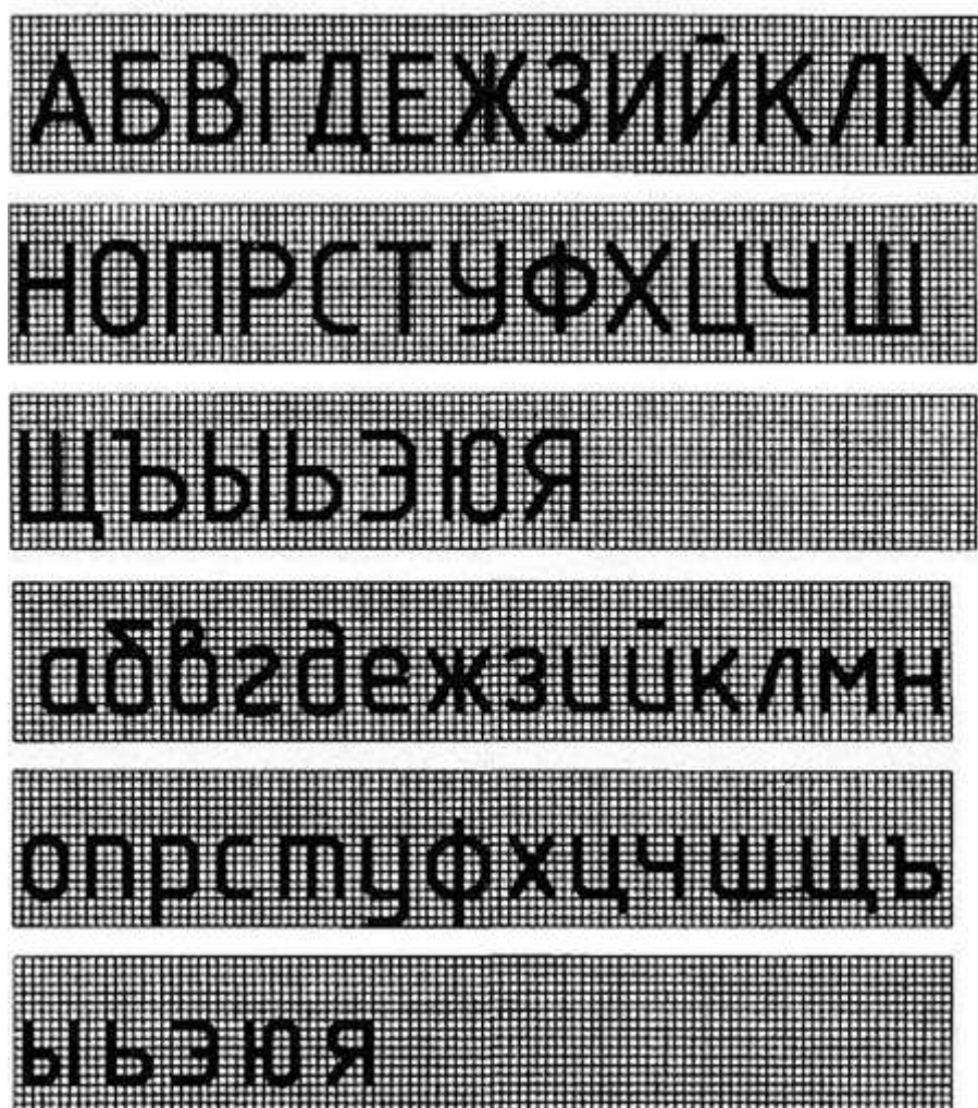
Рисунок К.2 – Шрифт типа Б без наклона
